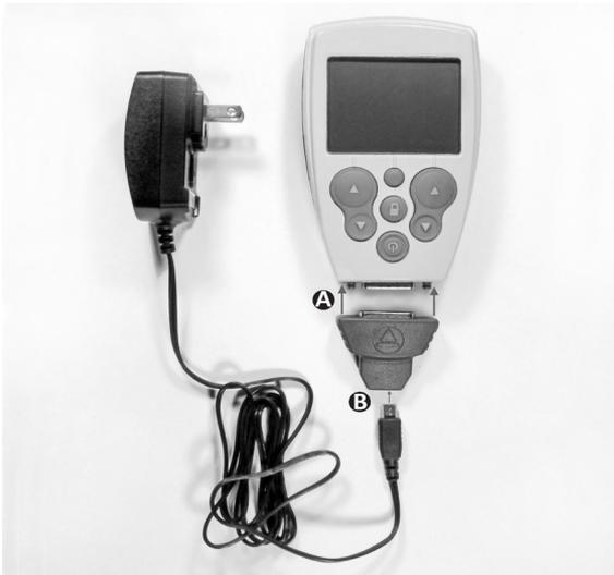
**Figura 4. Colocación del adaptador de carga (A) y el cargador (B).**
