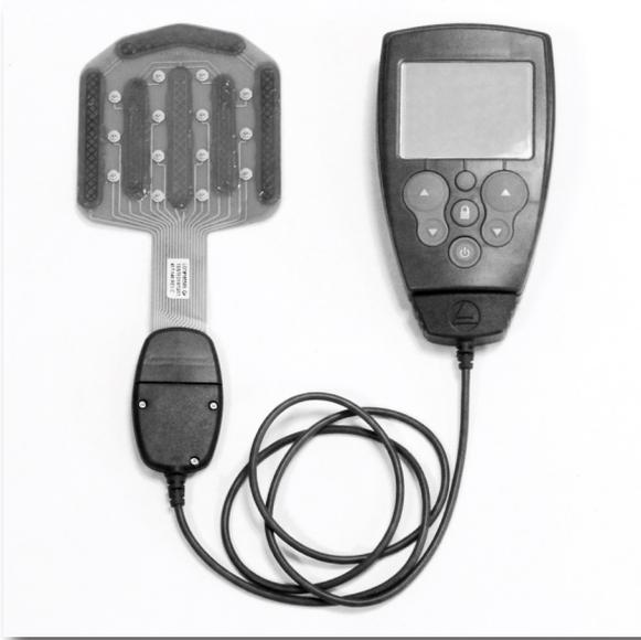
Figura 7. Sistema CFS 2.0 totalmente ensamblado.
